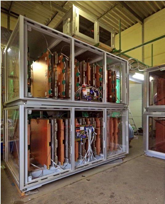
© Fotó: Oláh László A Szakuradzsima-vulkán magyar-japán együttműködésben fejlesztett müografikus megfigyelő rendszere.
