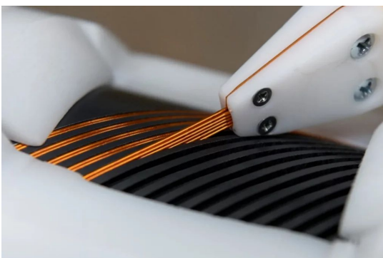
© Wigner Fizikai Kutatóközpont A SuShi szupravezető mágnes tekercselése.
