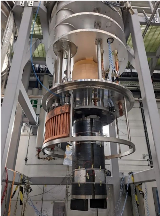
© Wigner Fizikai Kutatóközpont A SuShi szeptum mágnes az Uppsalai Egyetem "Gersemi" kriosztátjának belső struktúrájára szerelve.
