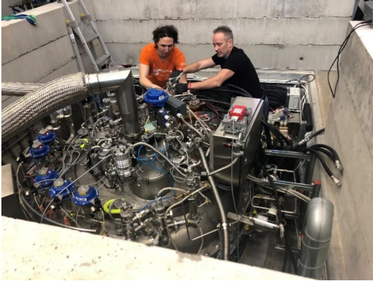
© Wigner Fizikai Kutatóközpont A "Gersemi" kriosztát az Uppsalai Egyetem FREIA laboratóriumában. Barna Dániel és Brunner Kristóf a nagy-áramú tápkábeleket csatlakoztatják.
